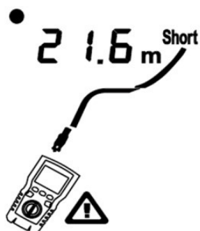
Figuur 6.16 Kortsluiting in coaxiale bekabeling
