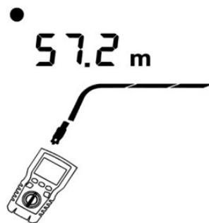
Figuur 6.15 Open op coaxiale bekabeling
